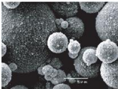
图 1: DOWSIL™ 9701 有机硅弹性体粉末的 S.E.M. 图片。
